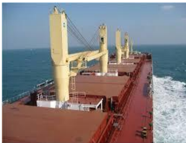
Slika 53 – Brodske dizalice u ležištima zatvorena grotla
