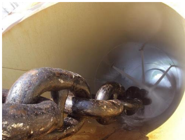
Slika 40 – Pranje sidrenog lanca u sidrenom ždrijelu
