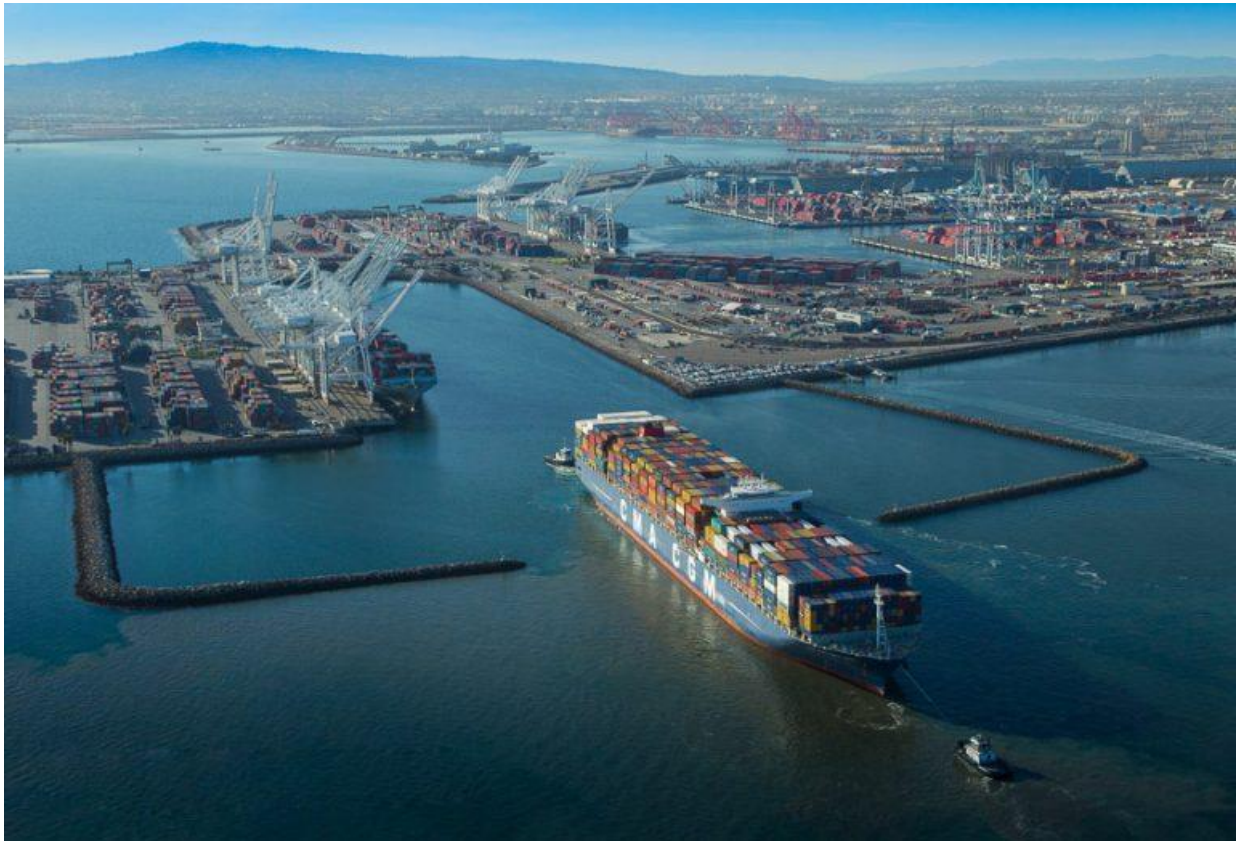
Slika 2 – Pristajanje broda uz obalu uz pomoć asistencije dvaju tegljača
