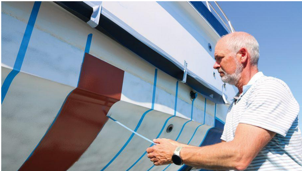
Slika 58 – Nanošenje antivegetativnog premaza na podvodni dio drvenog broda
