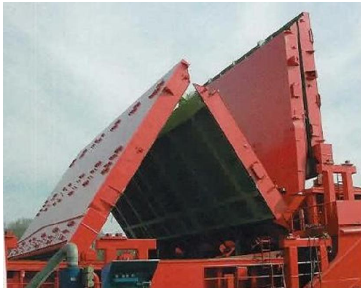
Slika 45 – Otvaranje poklopca skladišta Mc Gregor
