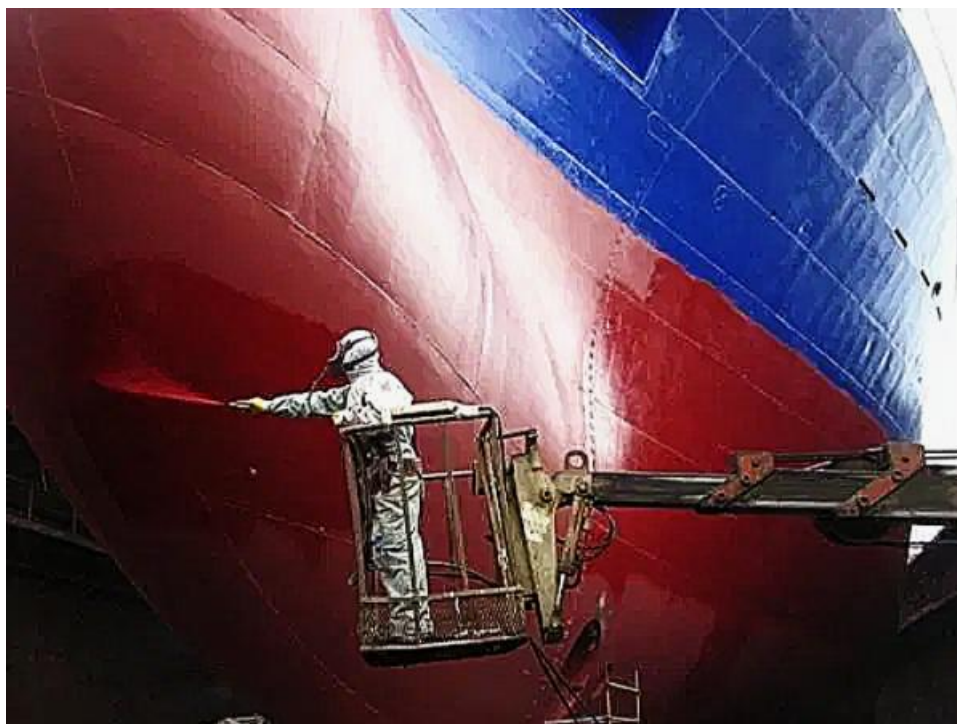
Slika 57 – Nanošenje antivegetativnog premaza na podvodni dio broda
