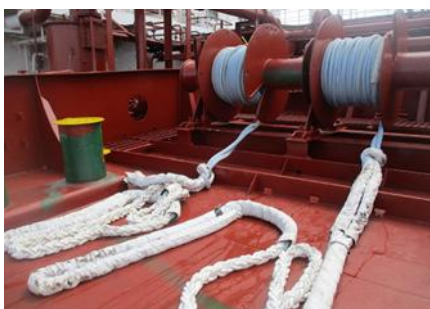
Slika 5 – Brodski konopi namotani na bubanj i složeni u košare na palubi broda
