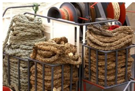
Slika 5 – Brodski konopi namotani na bubanj i složeni u košare na palubi broda
