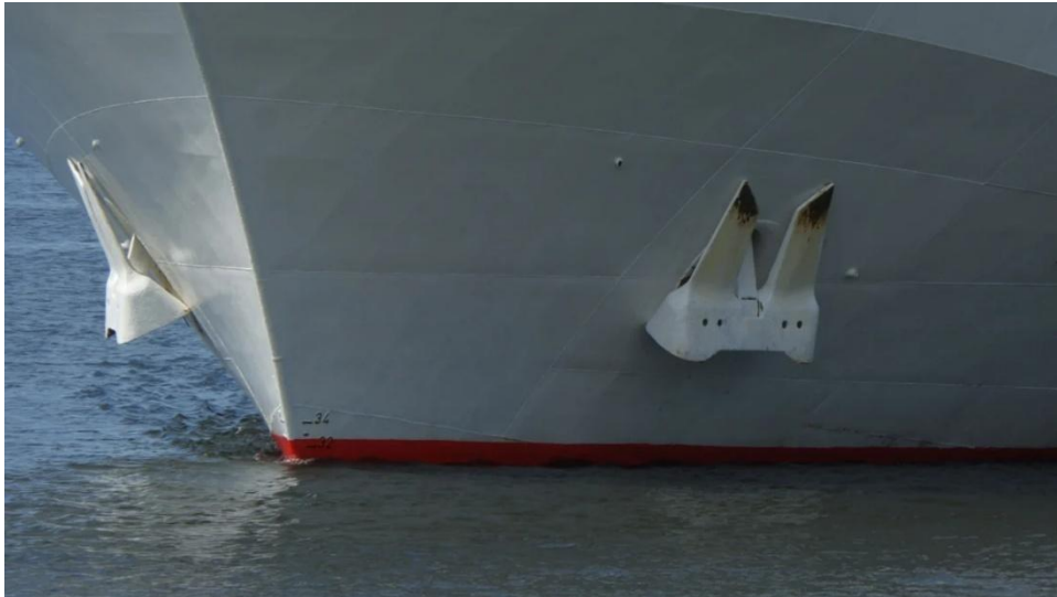
Slika 54 – Ispravan položaj brodskih sidara broda u plovidbi
