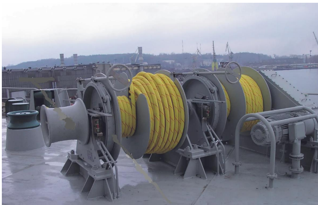
Slika 52 – Privezna užad složena na bubnjeve priveznog uređaja (Windlass-a)
