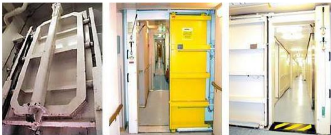
Slika 77. Vrste vodonepropusnih vrata
